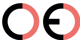
Faux marquage CE (trop éloigné)
